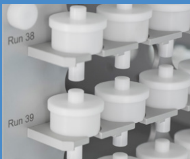
10 oder 40 Batch-Probenmagazin ermöglichen ein echtes 24/7 Testen.
