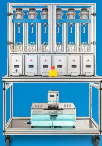
Испытание на высвобождение веществ *in vitro* из образцов жевательной резинки в окружающую жидкую среду
