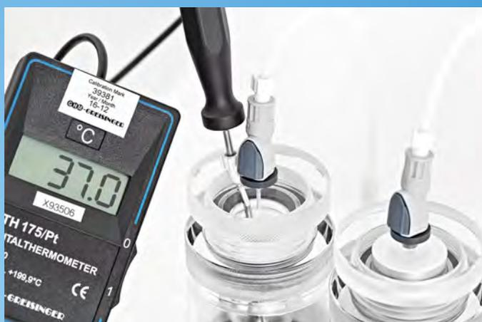
Специальная крышка для калибровки температуры внутри ячейки
